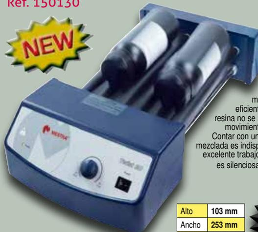
Dispositivo para el agitado de botellas de resina. El movimiento es doblemente giratorio, por lo que la acción de mezcla es suave y altamente eficiente. Las características de la resina no se llegan a alterar debido a un movimiento excesivamente energético. Contar con una resina homogéneamente mezclada es indispensable para conseguir un excelente trabajo de impresión. La máquina es silenciosa y dispone de regulador de velocidad de giro.
